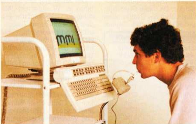
Mit dem Mensch-Maschine-Interface (MMI) können Behinderte mit dem Mund einen PC bedienen
